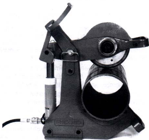
图 9—管子在割管机上就位。
