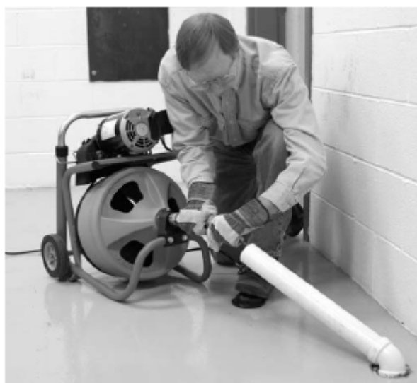
图9 — 使用延长管来保护钢索
