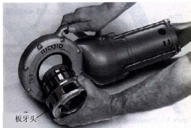
图 3—安装 No.12-R 板牙头
