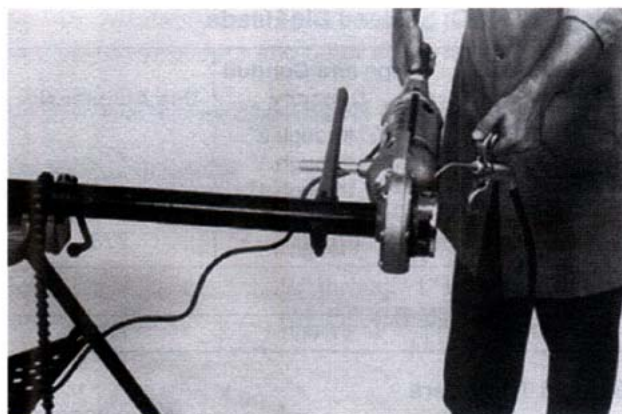
图 7—用管子钳作为支臂来套丝
