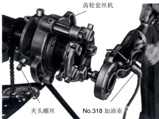
图 8—用齿轮套丝机套丝
