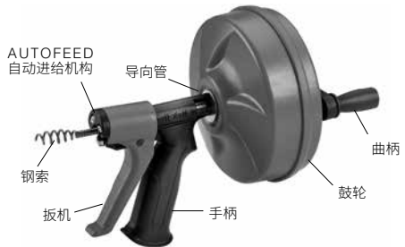
图 1 – POWER SPIN+ R3 管道疏通机
