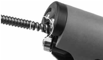
图 9 - 钢索末端钢索绕线中的开口
